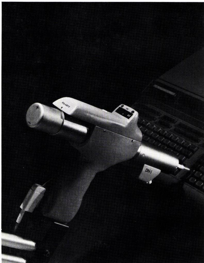
Pistolet de simulation de décharges (Keytec 2000).
