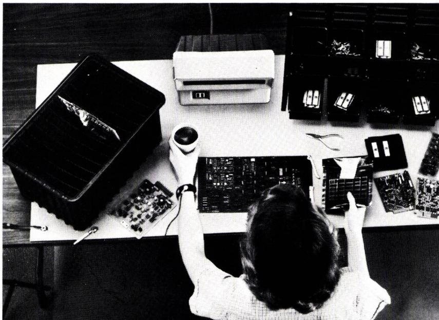
**Fig. 3 : Poste de travail équipé du système complet 3 M pour la manipulation en toute sécurité de composants sensibles à l'électricité statique.**
