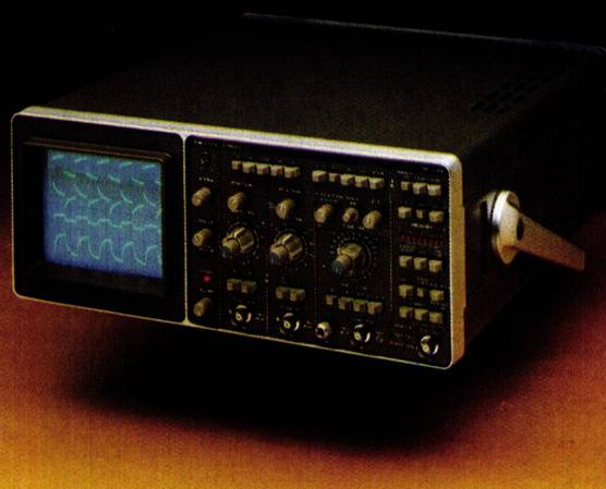
Le PM 3305 est un oscilloscope numérique 4 voies, 4 K mémoire, échantillonnant à 2 MHz. Un mode échantillonnage séquentiel permet de l'utiliser jusqu'à 35 MHz sur signaux répétitifs.
