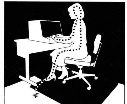
Fig. 7b : Sol conducteur : les charges accumulées par l'opératrice sont éliminées par contact avec un sol conducteur relié à la terre.
