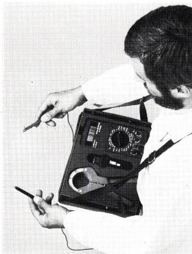
de 10 mA à 1000 A. Cet ensemble facilitera grandement la tâche des utilisateurs des services d'entretien de toutes les industries, des dépanneurs et installateurs électriciens et, des services comptage/mesure ou autres de l'E.D.F.
