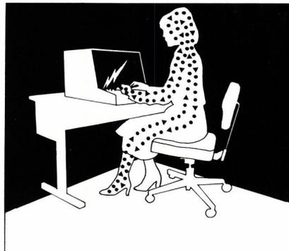
Fig. 7a : Sol non conducteur : les charges accumulées par l'opératrice ne peuvent s'écouler et sont transmises à l'ordinateur dès qu'elle touche le clavier.
