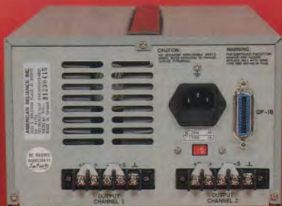
La face arrière avec les borniers à vis destinés à minimiser la résistance de contact aux fortes extrémités. Ici les liaisons type Kelvin sont inhibées pour travailler normalement depuis la face avant.
