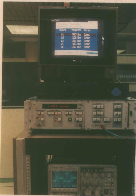
Mesures du rapport signal à bruit du terminal VISIOPASS de France TELECOM.
