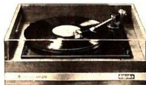
**Réf. PC 10** - Table de lecture semi-automatique, moteur synchr., vlt. 16, 33, 45 tr/mn, plateau lourd (2 kg), Ø 28 cm, équilibr. dynam., bras tubul., contrepoids de régl. 0 à 5 g, cellule magnét. (fix. standard), anti-skating, lève/repose-bras à viscosité, bande pass. 20 à 20 000 Hz - Dim. 450 x 350 x 175 mm, av. capot plexi.
