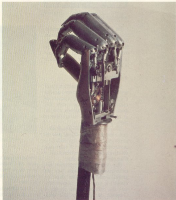
Fig. 4 - Une application de la peau artificielle dans le domaine de la préhension automatique. Ici l'étude d'une prothèse de main.
