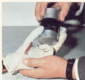
Fig. 13. - Lorsque l'objet est un corps dur, chaque traction entraîne un plus fort serrage.
