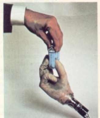
Fig. 15. - Lorsque la traction est importante, la main « sature » : son petit doigt s'enroule totalement.
