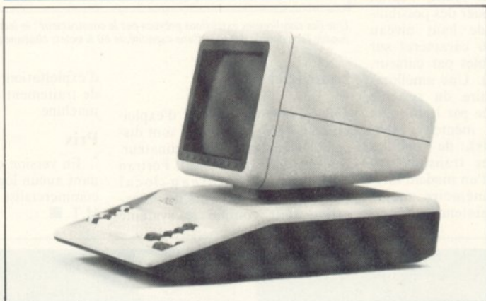
Le micro-ordinateur AXEL 20. Remarquez, sur la tranche, le lecteur de disquettes intégré.
