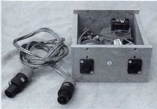
Photo 7 : le filtre avec le câble d'interconnexions
