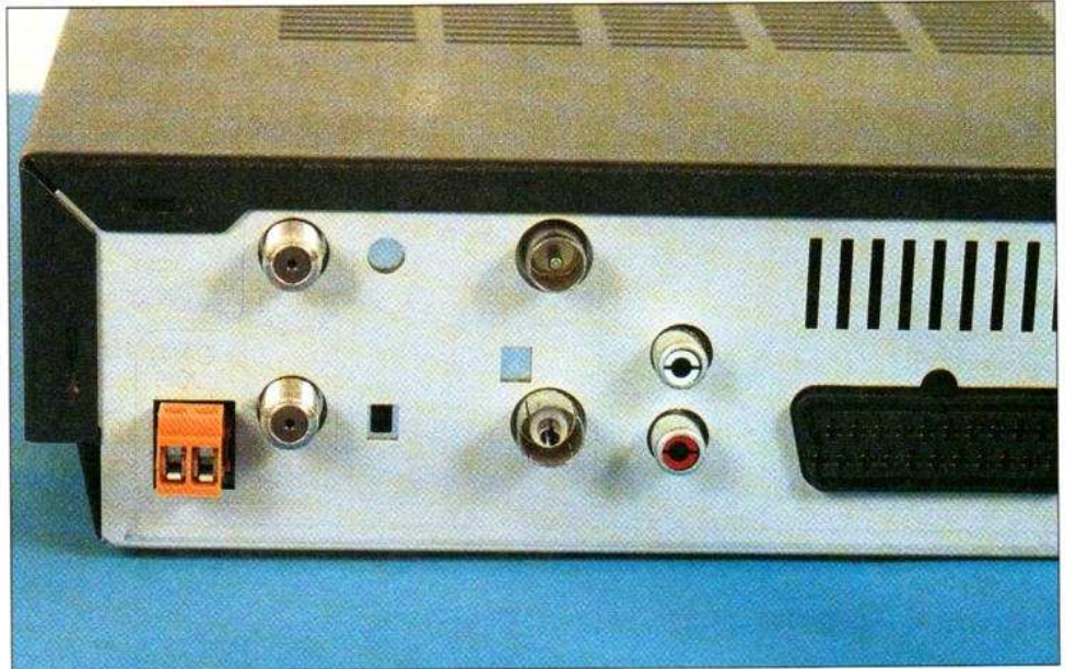
Une prise orange déconnectable alimente un polariseur magnétique. Le récepteur est équipé d'un modulateur à synthèse de fréquence. Les deux entrées RF à prise F délivrent à la demande une tonalité à 22 kHz.
