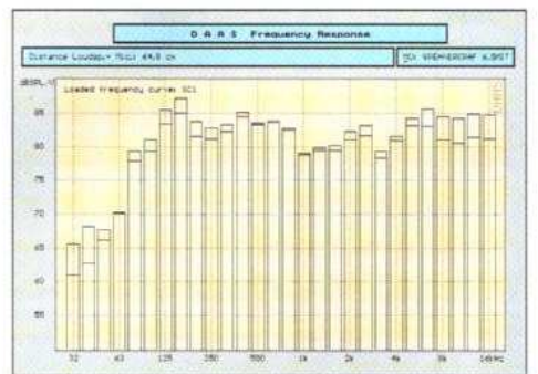
Courbe de réponse dans l'axe et efficacité. Relevée avec une 6.5 montée dans une enceinte SE1612, la réponse se révèle un peu physiologique. Les deux tracés correspondent aux réglages 0 et -3 dB de la face avant
