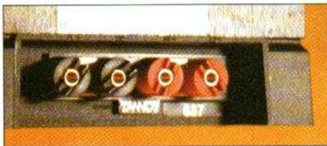
Le bornier de bi-câblage. On passe facilement au mono-câblage en faisant glisser les barrettes dorées (difficile de les perdre).
