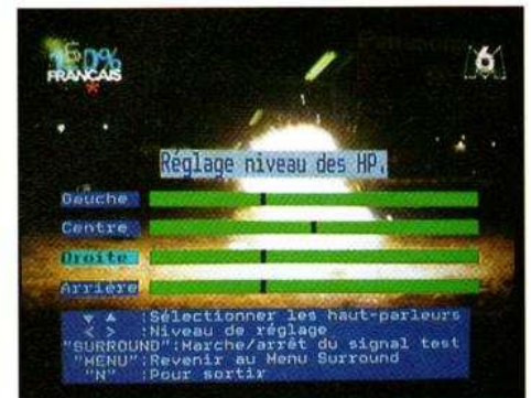
Le réglage du niveau des HP s'effectue avec un signal d'essai ou avec le son TV.
