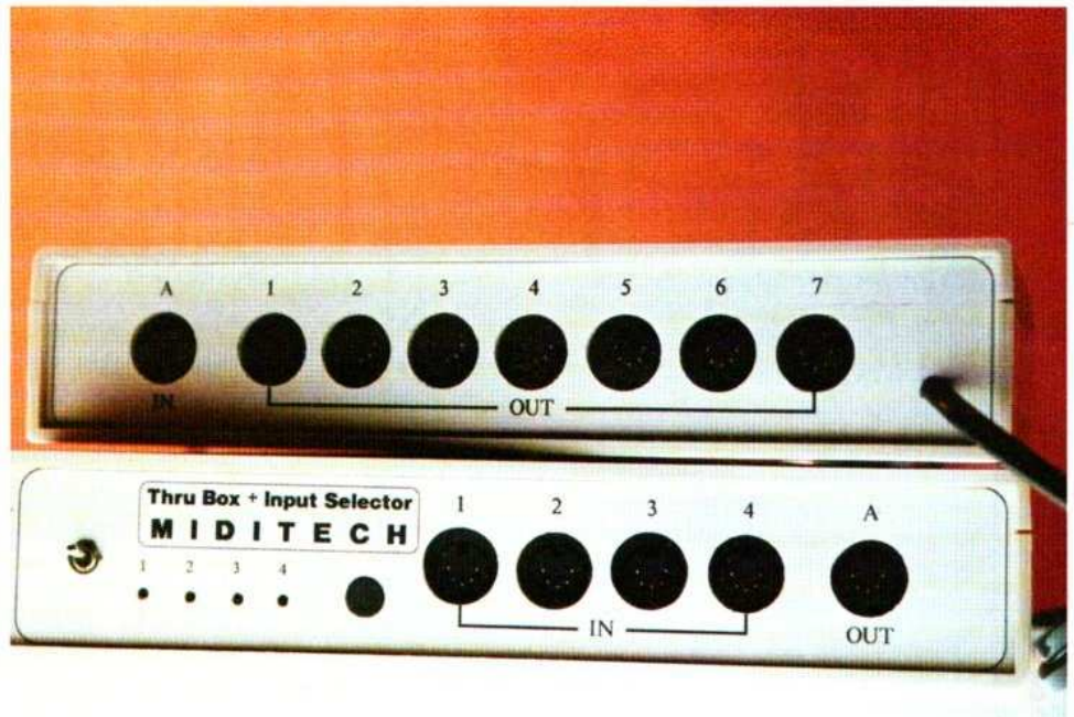
Le "patch" Miditech: côté sélecteur d'entrée et côté Thru Box. Achevés et testés, ceux là sont bons pour le service.
