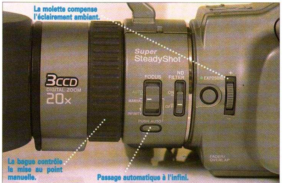
Détail des commandes de l'objectif : nous avons ici un ensemble de commandes très commode à exploiter.
