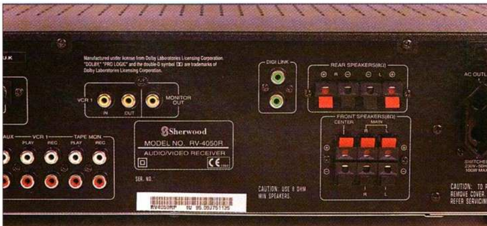
Détail de la face arrière, la marque "CE" est bien là. Les prises RCA vertes s'associent au bus inter-appareils, les jaunes sont celles de la vidéo. Sur ce modèle, le panneau arrière est relativement désert...
