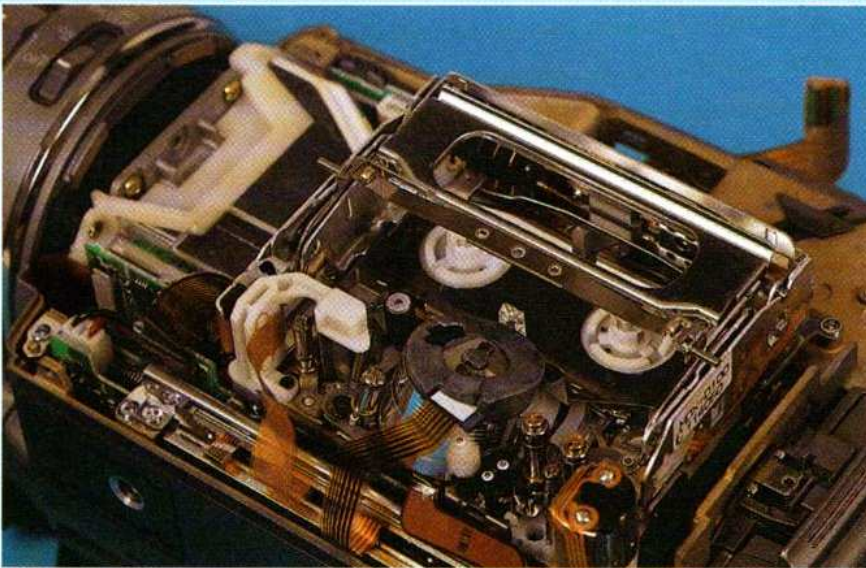
La platine utilise un tambour rotatif surmonté d'une génératrice tachymétrique optique. On aperçoit le petit cylindre de nettoyage. Au fond, la partie argentée abrite le prisme et les trois capteurs CCD.
