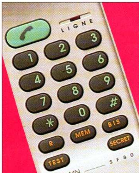
Le combiné comporte, disposées sur trois colonnes, 14 touches, d'abord, les touches numériques de 1 à 9, le zéro étant, lui, encadré par les touches * et #.
