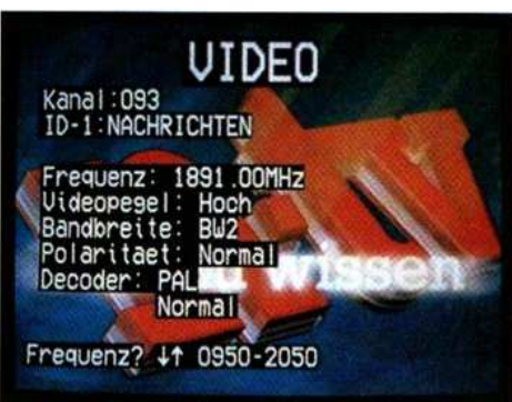
Ce menu sert au réglage des paramètres de réception. Nous l'avons ici en allemand, il existe aussi en anglais.
