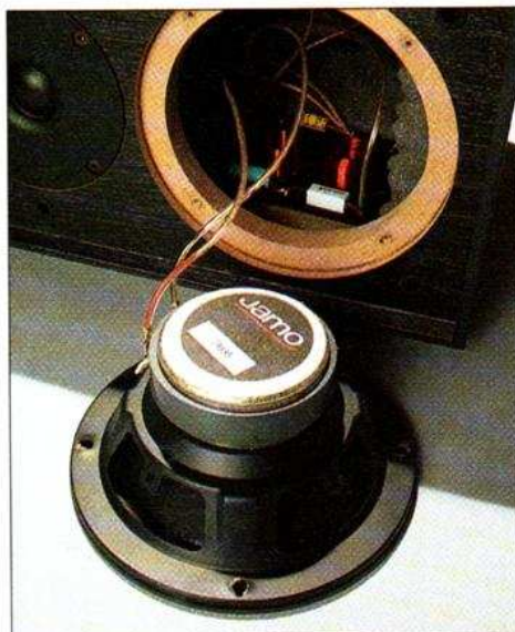
Jamo utilise des selfs sur air pour ce modèle.
