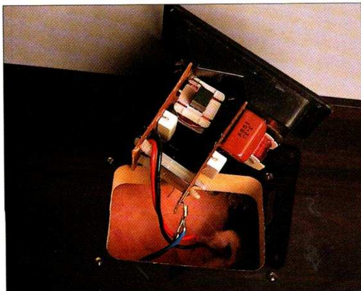
Condensateurs à diélectrique plastique, sels sur air ou bâton de ferrite : un filtre soigné pour audiophiles.
