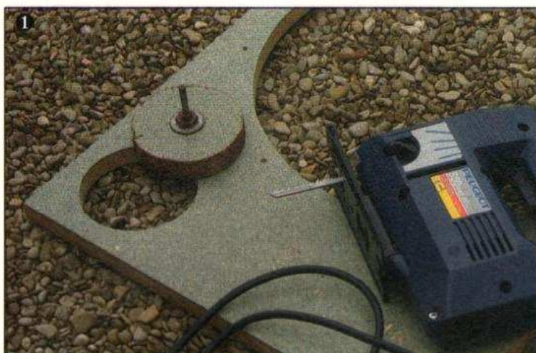
1 La découpe de la face avant : on utilise une scie sauteuse, la chute des trous de 100 mm est ceinturée d'un abrasif et montée sur un axe, elle sert à la finition des trous.
