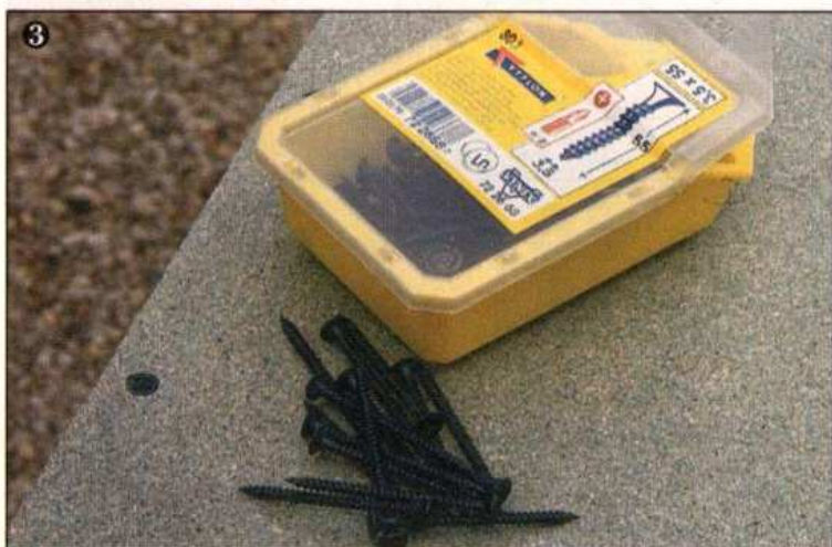
3 Une technique d'assemblage rapide : nous utilisons des vis à tête trompette de 3,5 x 55 mm, ici revêtue d'un anti-adhérent. Il est préférable d'amorcer les trous du panneau horizontal, fraisage compris.
