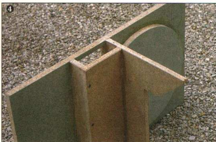
4 La face arrière a été équipée du logement du processeur, de la cloison interne et de la chute de découpe de l'emplacement du transducteur.
