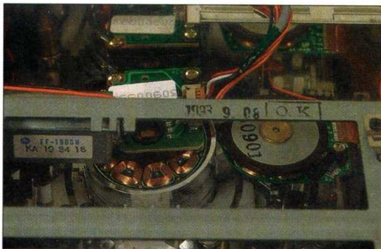
Détail sur la motorisation de la platine 8 mm. A gauche, les bobinages du moteur du tambour vidéo, à droite, l'aimant du rotor du moteur de cabestan, le petit bloc noir est un capteur tachymétrique.
