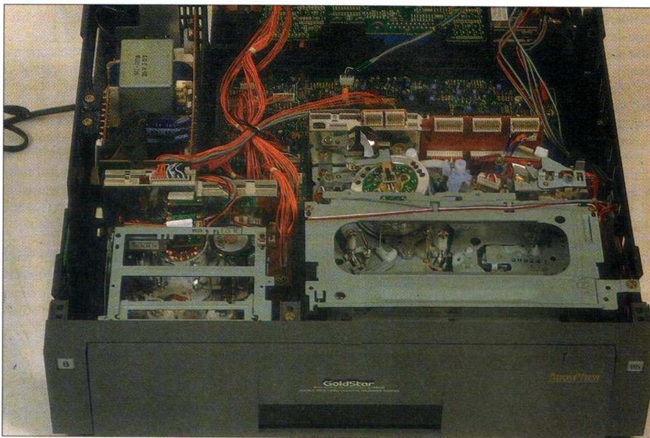
Les deux platines : microscopique pour le 8 mm, plus imposante pour le VHS... Un contraste saisissant.
