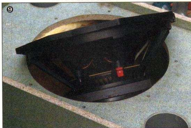
Des écrous à frapper enfoncés au marteau recevront les vis BTR de fixation du transducteur.
