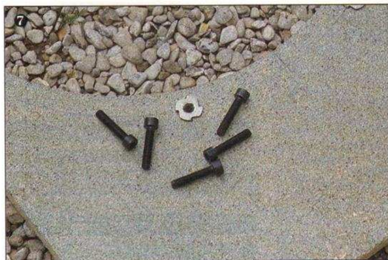
Des écrous à frapper enfoncés au marteau recevront les vis BTR de fixation du transducteur.
