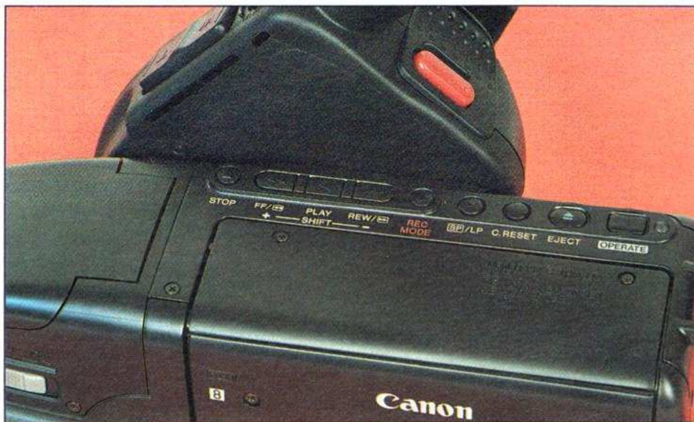
Le clavier supérieur est principalement utilisé pour la reproduction. C'est avec la touche « stop » que l'on passe en mode « prise de vues ».
