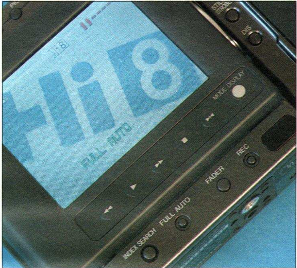
Sous l'écran, les touches portent les symboles d'un clavier de magnéscope, mais leur fonction peut changer, elles seront indiquées sur l'écran.
