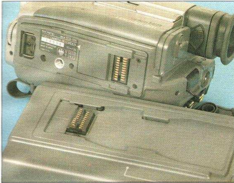
Des contacts qui se dévoilent automatiquement à la mise en place du caméscope sur son socle. Notez également sur l'avant un petit support articulé.
