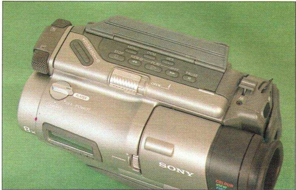
Un volet s'ouvre pour donner accès aux touches du magnéscope. Sur la droite, on voit le levier de zoom original, sur la gauche le levier chromé rotatif pour la sélection du mode de fonctionnement.
