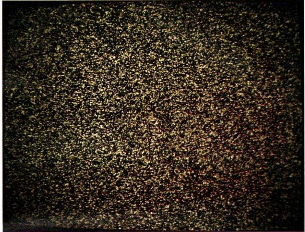
La présence sur l'écran d'une multitude de points lumineux est le signe soit de la coupure de la liaison avec les antennes de réception, soit de l'accord du tuner sur un canal non capté sur le site.
