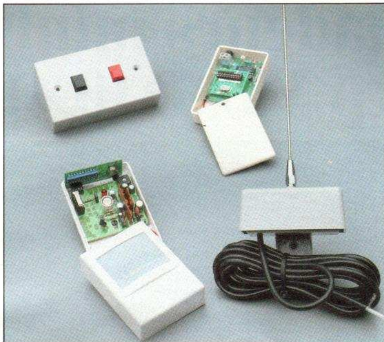
Emetteurs. Au premier plan à gauche, un détecteur de présence à infrarouge. Remarquer sur sa partie gauche, près de la barrette de programmation, un interrupteur qui ferme le circuit de déclenchement si l'intrus ouvre ou casse le boîtier.
