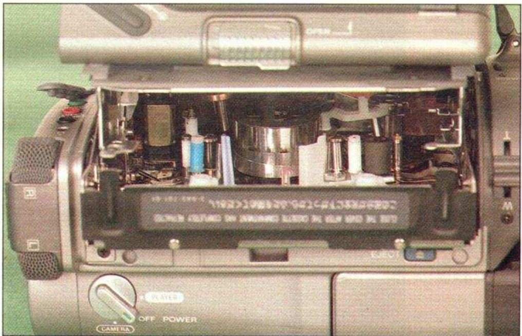
Le tambour vidéo, tout au fond du logement de la bande, notez la forme particulière de l'interrupteur/sélecteur de mode.
