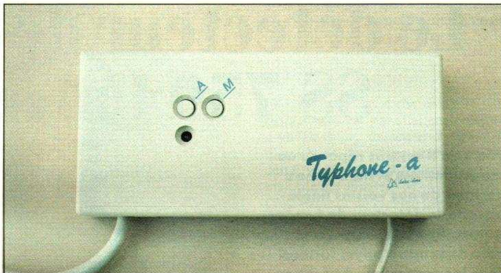
Deux poussoirs et une LED en face avant permettent une commande manuelle.
