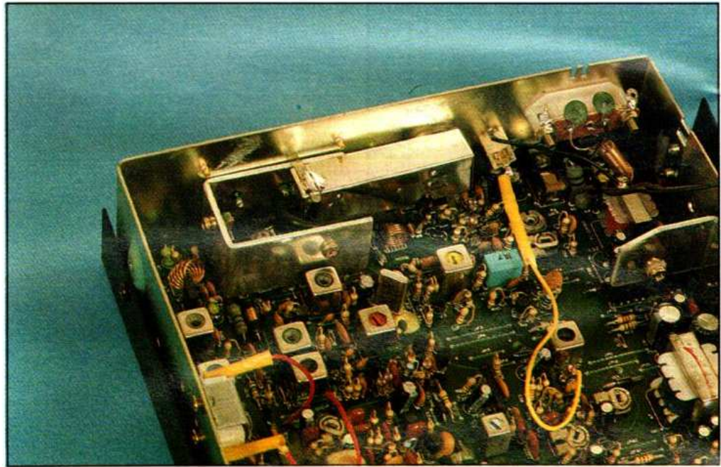
Vue interne du poste EuroCB. La section de puissance : le radiateur suffit pour la puissance de 4 W imposée par la réglementation française. Le circuit imprimé est en verre époxy, la fabrication traditionnelle, on n'a pas cherché spécialement ici à aligner les composants.
