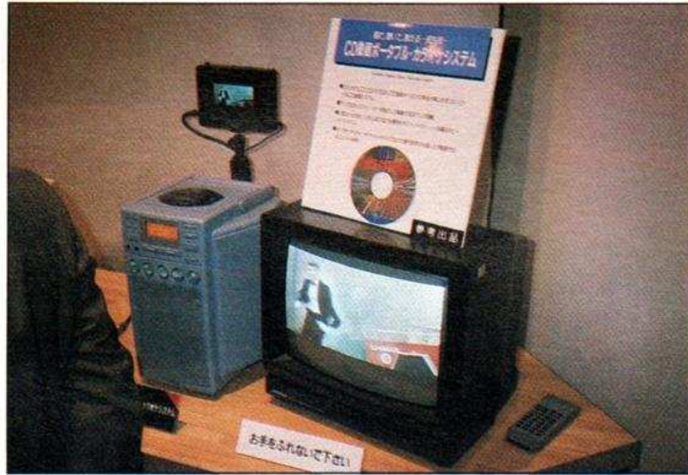
Karaoke à changeur de disques. Les disques ont 12 cm de diamètre, et vidéo et audio sont enregistrés en numérique.
