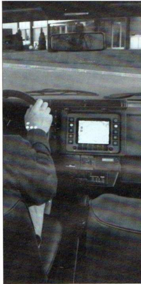
Renault 25 : on voit très bien, sur cette photo, l'écran principal au centre de la planche de bord et la « vignette » placée à droite du compteur de vitesse (photo Renault).
