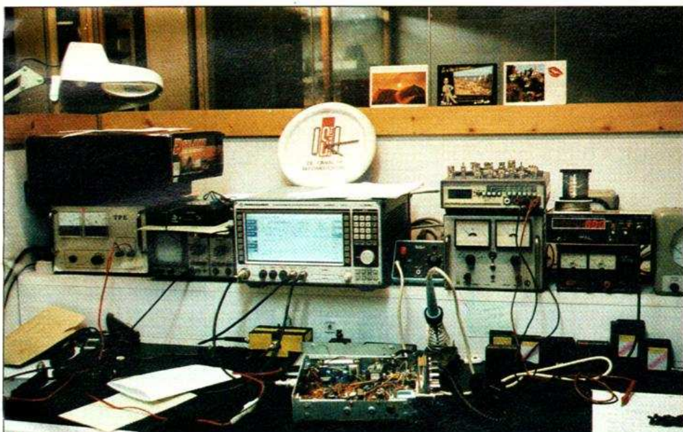
L'atelier service après-vente. Remarquez un bel outil : l'analyseur HF Rohde et Schwarz.
