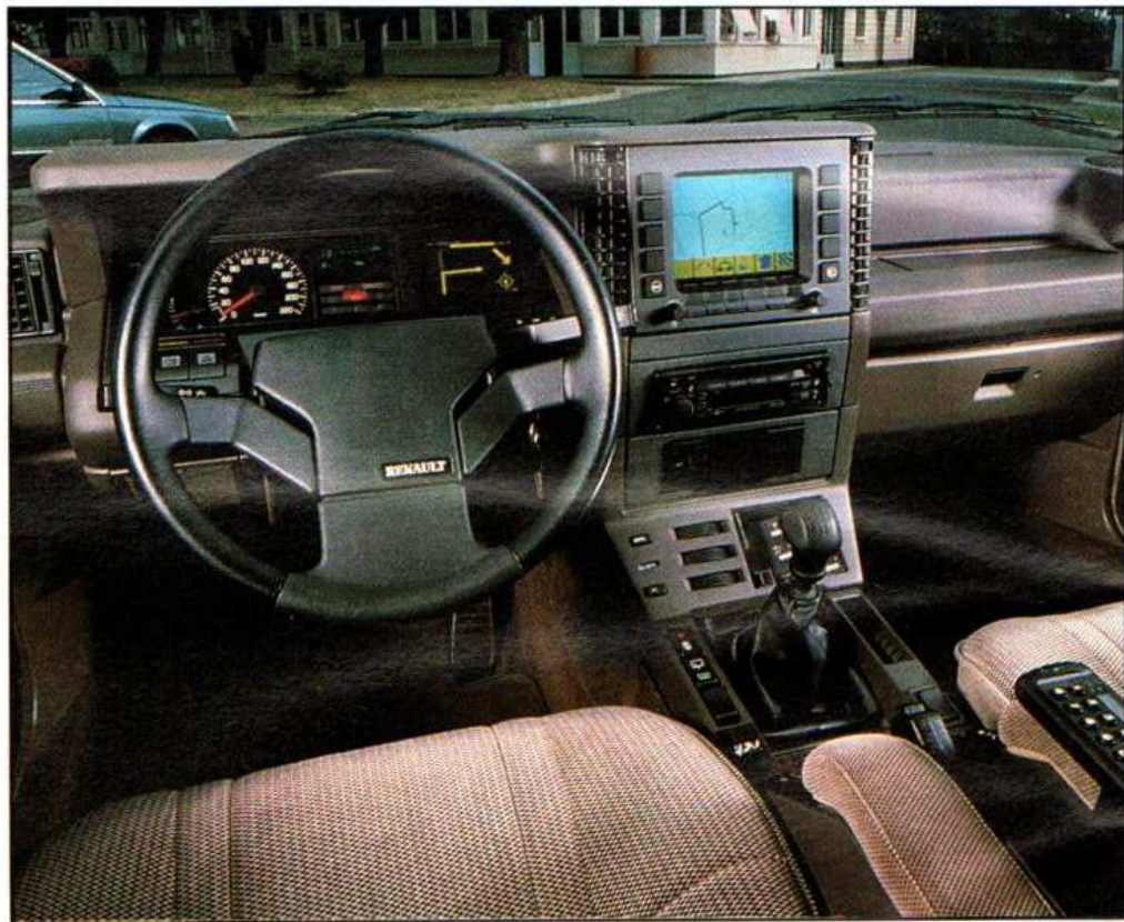
Renault Express : l'intégration de l'écran principal ne pose pas de problème, même dans un habitacle de petite dimension, ici une Renault Express (photo Renault).
