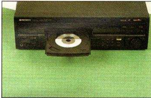
Le tiroir est ici en mode CD, seule la partie centrale sort, avec une course limitée.
