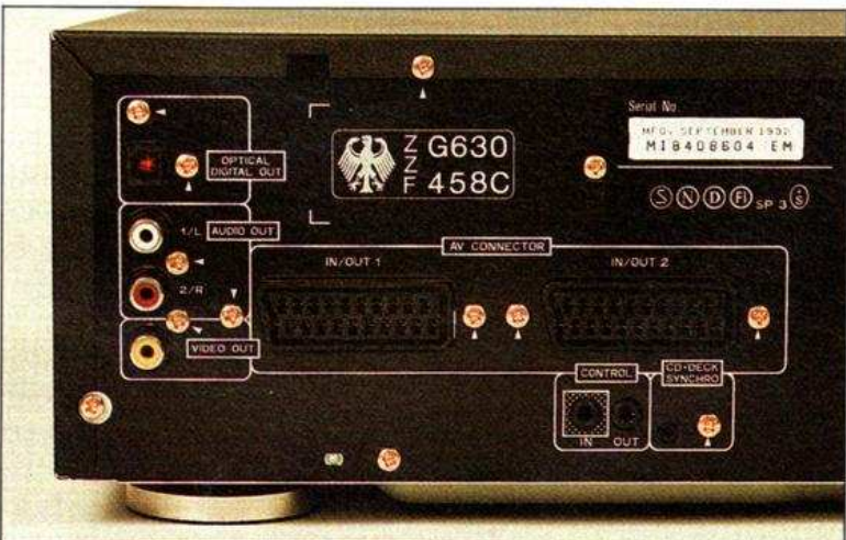
Deux prises Scart, quelques RCA, une sortie numérique optique, des jacks pour des commandes par bus ou pour un enregistrement synchrone de CD.
