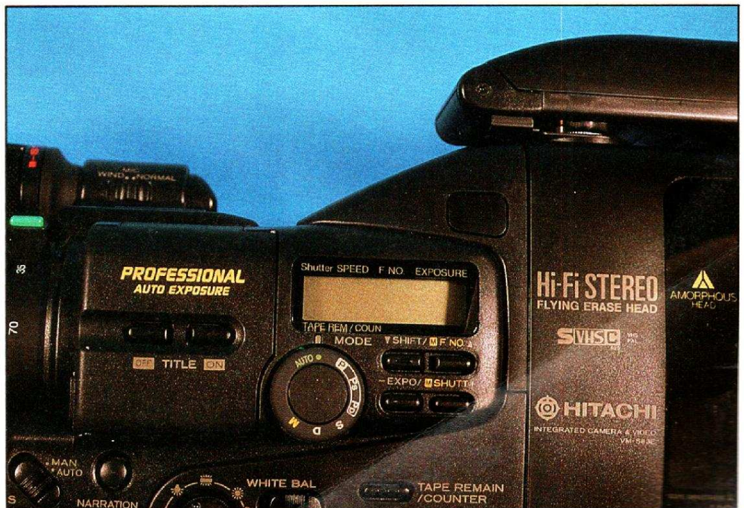
Tendance, lancée par Hitachi en 1990 : des programmes d'exposition (ins., vitesse) inspirés des pratiques de la photographie. On dispose de priorités à la vitesse ou au diaphragme, ainsi qu'un double degré de valeurs intermédiaire pour ces paramètres : 13 combinaisons en tout.
