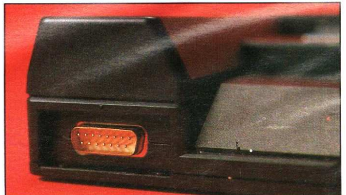
Sur le « Classe affaires », la prise de liaison pour le « kit » voiture est protégée par une trappe en utilisation portable.
