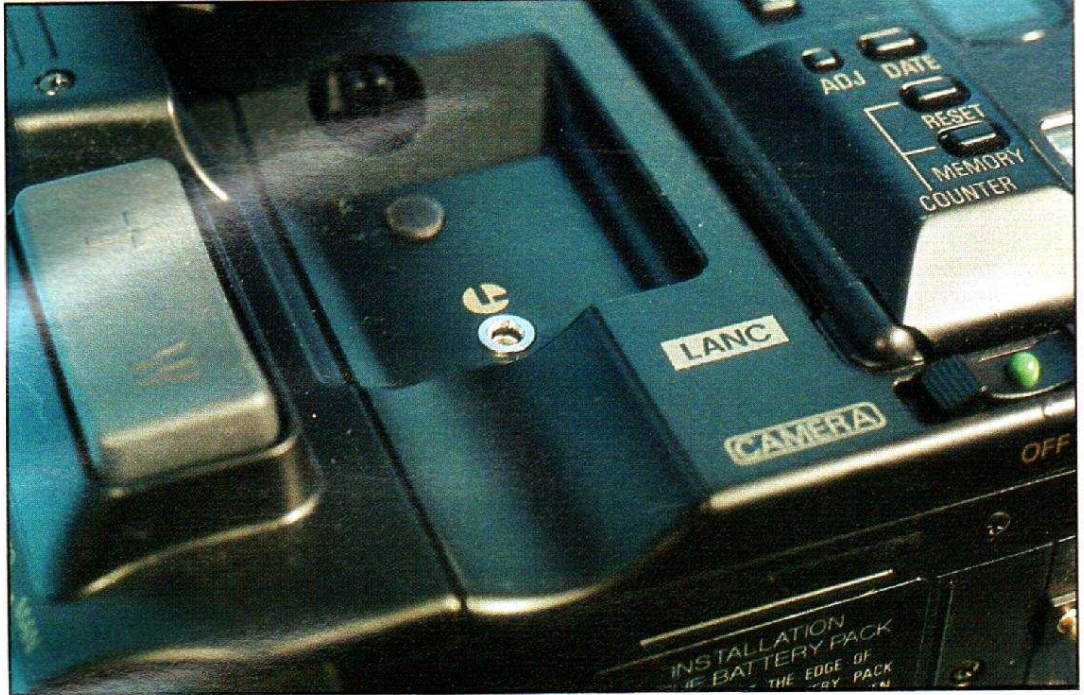
LANC. Qu'est-ce ? C'est l'abréviation de Local Application Communication bus. La prise coaxiale est destinée à acheminer des ordres de télécommande pour la section magnétoscope. On rencontre cette prise sur les appareils 8 mm, les modes d'emploi n'en font pas mention ; mais, tous renseignements pris, ce serait là l'ébauche d'un bus pour la copie commune aux caméscopes 8 mm et à des tables de montages ou autres périphériques futurs. A suivre...
