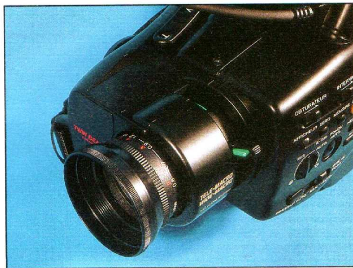
Rare : une mise au point automatique par double rayon infrarouge, efficace en toutes circonstances ; plus rare encore : une double position « macro » exploitable tant en téléobjectif qu'en grand angle (Hitachi VM-3300).
