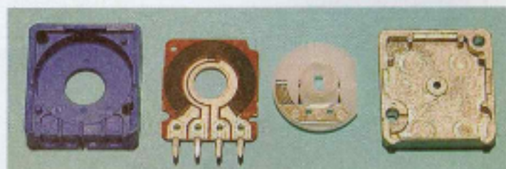
Photo 1 : Potentiomètre à six voies. Ci-dessus, les éléments constituant l'une des six voies.
