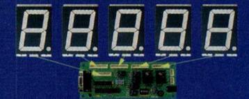
Cette platine peut piloter jusqu'à 5 afficheurs 7 segments "géants" (117 x 85 mm) via un port série RS-232 (depuis un module PICBASIC ou un compatible PC) ♦ Alim.: 15 Vcc (non livré).
