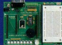
Cette platine dispose d'une plaque de connexion sans soudure (192 cts), d'un buzzer, de 8 leds, 8 BP, d'une interface RS232 (niveau TTL et comp.PC) + zone de développement + 25 supports pour "modules" spéciaux (non livrés) équipés de composants (idéal pour manipulations sans connaissance particulière) ..... 480 F
