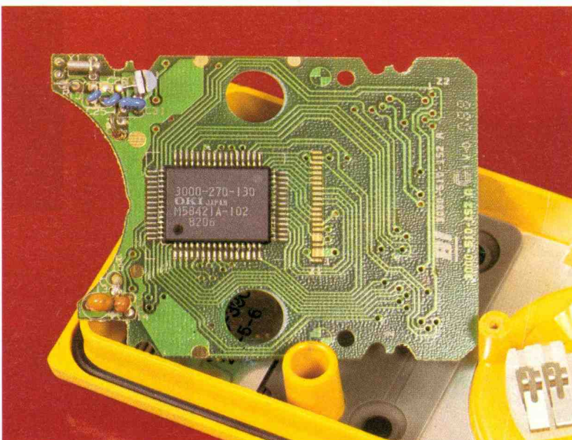
Photo 3. – Vue du circuit intégré pilotant l'appareil.
