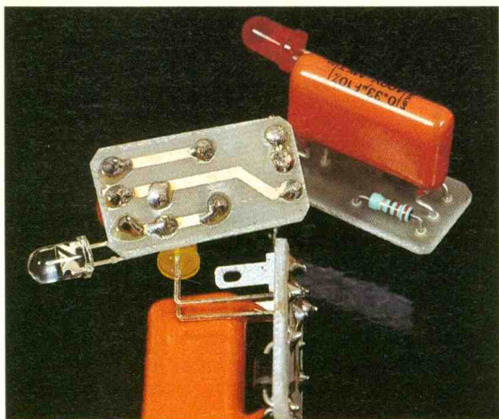
Photo 2. - Le circuit imprimé réduit à sa plus simple expression.
