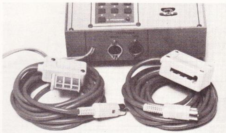
Photo 5. – Le raccordement du montage s'effectuera à l'aide des prises standardisées pour téléphone.
