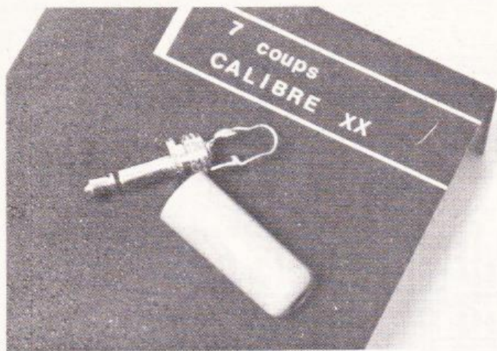
Photo 3. – Une fiche Jack 3,5 mm servira, grâce à son strap, d'interrupteur marche/arrêt.
