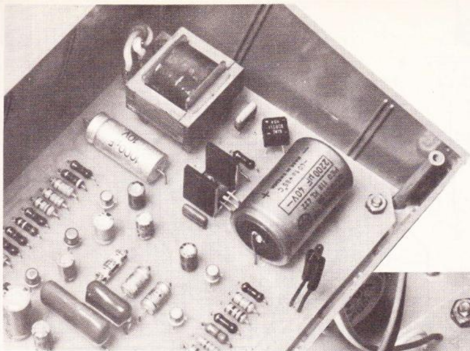
Photo 2. – Gros plan sur la section alimentation confiée au transistor de puissance BD 135.
