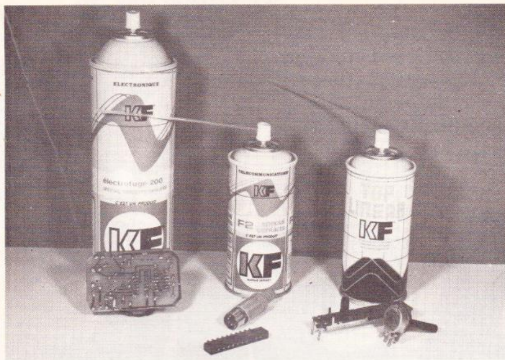
Photo 4. – Trois bombes bien utiles, un vernis spécial pour circuits imprimés, un décapant de contacts et un rénovateur de potentiomètres.
