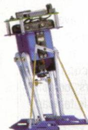
**The Toodler** est un robot bipède fonctionnant grâce à deux servomoteurs et un BASIC Stamp 2 (monté en surface sur la carte du Toodler). C'est un kit de qualité dont le châssis est en aluminium. Il mesure
