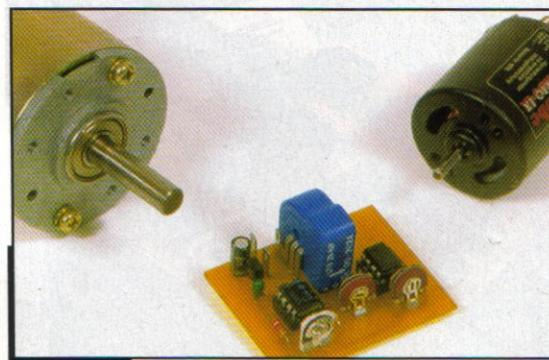
Le capteur permet de mesurer de très forts courants tel celui de démarrage d'un moteur, c'est une alternative, sans contact à un shunt de très faible valeur tel celui présenté ici.
