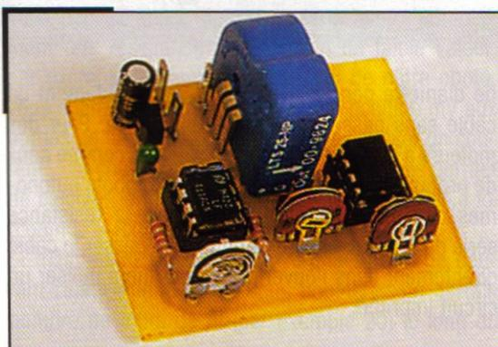
Le montage dispose d'un régulateur de tension intégré. Pièce maîtresse, un capteur de courant.
