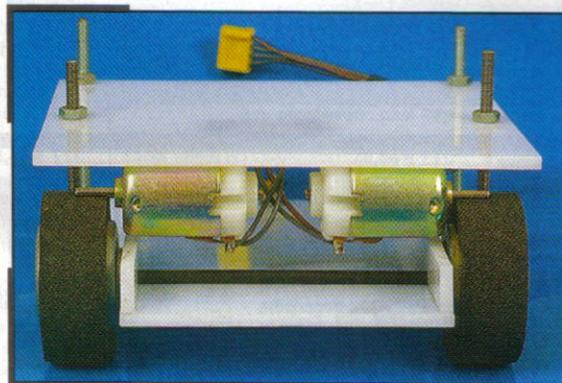
▶ On applique directement l'axe moteur sur la bande de roulement de la roue.
