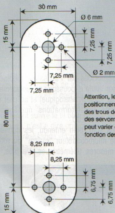
Attention, le positionnement des trous de fixation des servomoteurs peut varier en fonction des modèles
