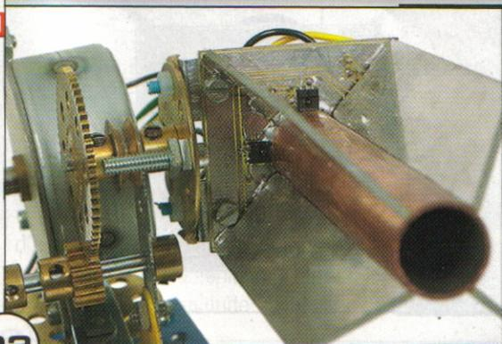
détectée, nous passons en phase accrochage et le système élabore en permanence une ligne de visée vers la source identifiée. Dans le même temps, le microcontrôleur activera la commande d'alimentation du laser, permettant de visualiser cette ligne.
