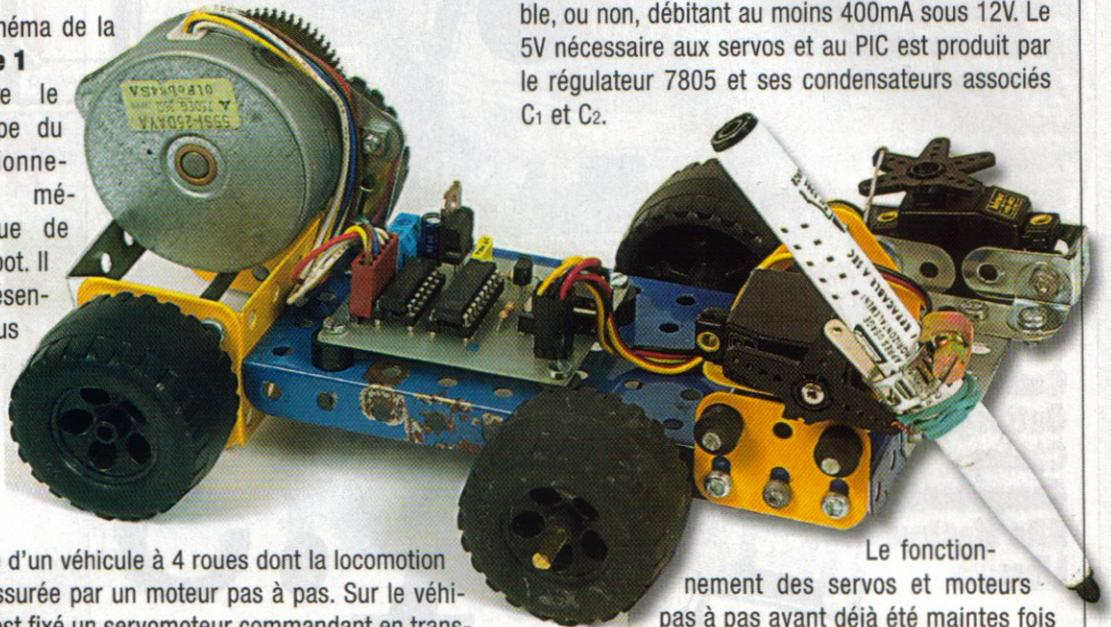
forme d'un véhicule à 4 roues dont la locomotion est assurée par un moteur pas à pas. Sur le véhicule est fixé un servomoteur commandant en translation un chariot mobile. Enfin, fixé sur ce chariot mobile, un autre servomoteur assure la descente et la montée d'un stylo solidaire de ses bras.
