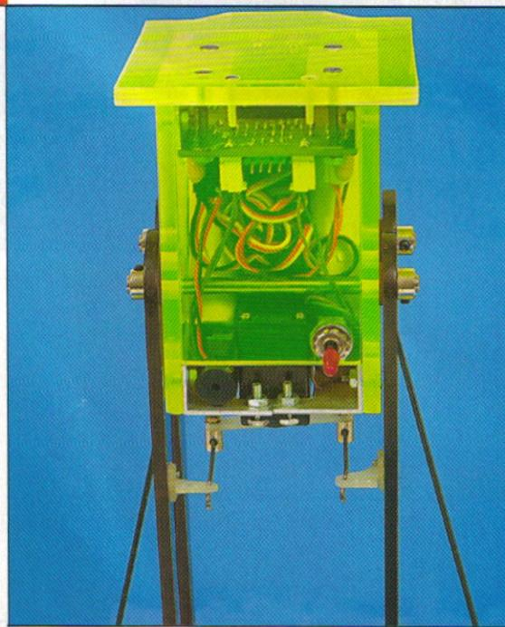
On termine par fixer aux bouts des deux tiges filetées de 200 mm, les quatre rotules en plastiques. Les quatre rotules mâles en métal sont fixées deux sur le palonnier du servo à l'avant et les deux autres, un sur chaque pied.
