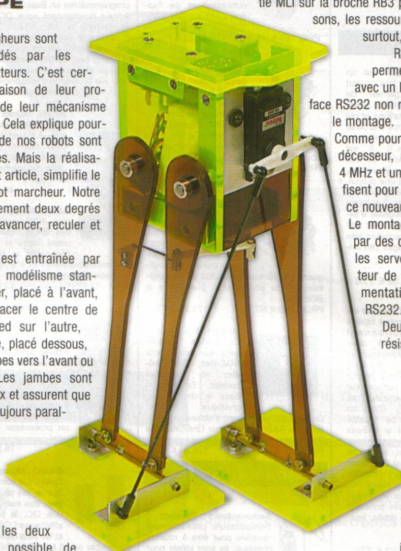
tie MLI sur la broche RB3 pour générer des sons, les ressources internes et, surtout, les deux lignes RB1 et RB2 pour permettre un dialogue avec un PC par une interface RS232 non représentée dans le montage.
