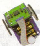
**Line Follower Module** : Module de suivi de ligne pour **BOE-Bot**. Il utilise 5 capteurs infrarouges et comporte tout le nécessaire de connexion et de fixation. Livré sans le **BOE-Bot**.
