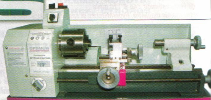
Pour preuve, le tour D140 x 250 Vario est une machine extrêmement précise (au 1/100ème), très performante et capable d'usiner des pièces atteignant 250mm de longueur sur 140mm de diamètre. Son variateur lui offre une large gamme de vitesses, ce qui en fait une machine très polyvalente, capable d'usiner un grand nombre de matériaux (acier, alu, P.V.C., etc.).
