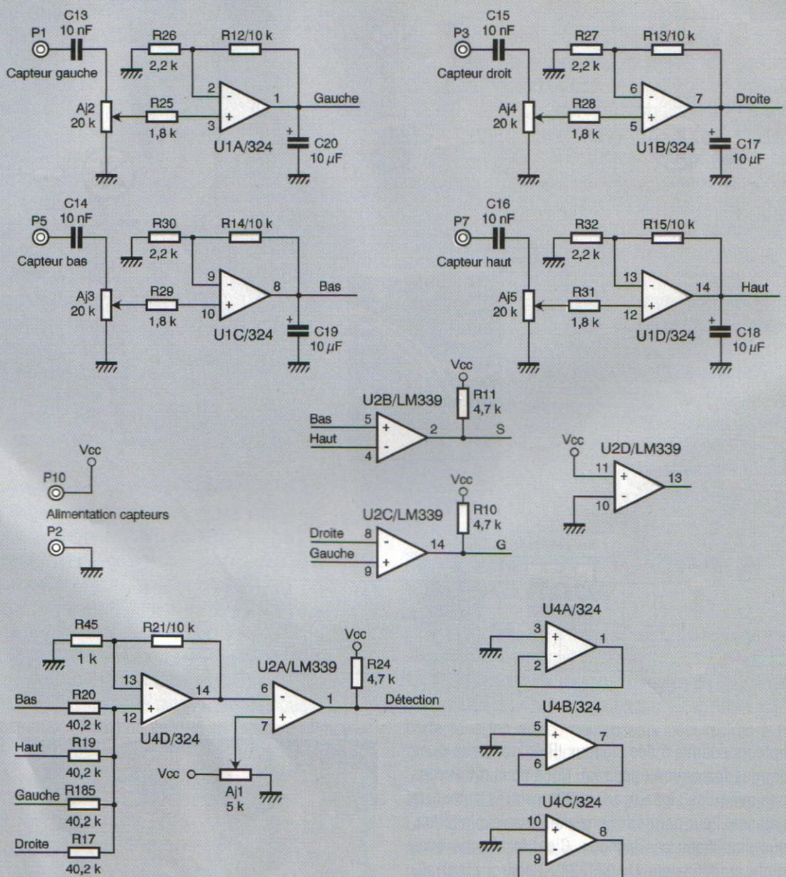
d'entrée. Un condensateur (C<sub>17</sub> à C<sub>20</sub>) à la sortie des amplis permet d'obtenir une tension continue proportionnelle à l'amplitude des signaux alternatifs de
