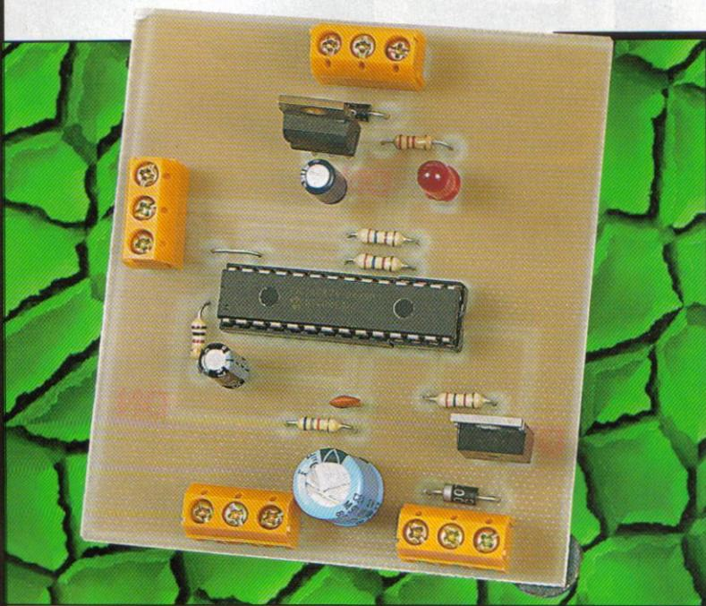
Le principal avantage de la PWM réside dans le fait que la commande de puissance du moteur est très souvent réalisée par un transistor de type MOSFET fonctionnant en commutation : puisqu'il n'y a que très peu de pertes, le rendement est donc excellent. Même à faible vitesse, le couple disponible sur l'arbre du moteur reste élevé, ce qui rend un tel montage idéal pour, par exemple, une commande train modèle réduit.
