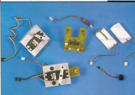
Le système de détection d'obstacles. Le condensateur C4 est placé côté cuivre.
