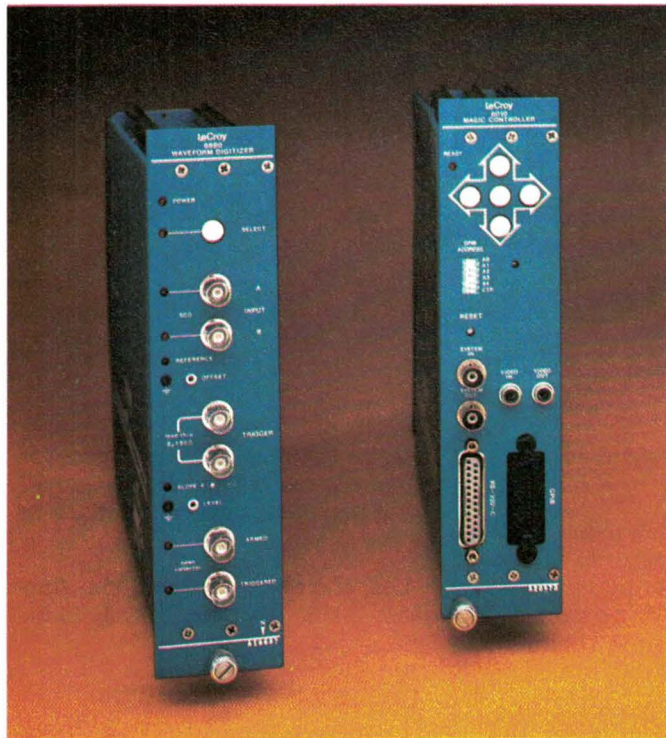
Modules digitaliseur (à gauche) et contrôleur (à droite).
