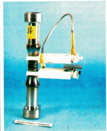
Extensométrie sur éprouvette à haute température à l'ONERA. L'extensomètre mis au point par M. Policella mesure des déformations de traction et de torsion. La course de 3 mm est mesurée à 0,1 micron près (doc. Fogale).
