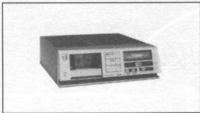
Fig. 1 : Prototype de magnétocassette audionumérique présenté par le groupe Matsushita en mars 1983. Il utilisait une cassette compacte standard équipée d'une bande métal. C'était une version 16 bits linéaire/44,1 kHz utilisant 12 pistes par face.
