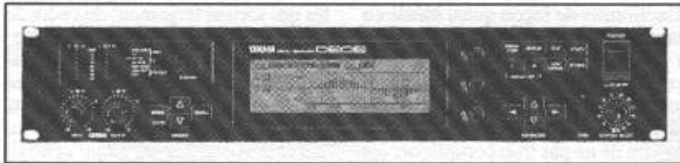
Fig 4 : Egaliseur numérique stéréo Yamaha DE Q5 (division audio professionnelle). C'est un égaliseur paramétrique aux possibilités très étendues, très performant que l'on peut associer à un maximum de 23 "esclaves" (DEQ 5E), voire à d'autres maillons Midi ou ordinateurs grâce à son connecteur RS-485.
