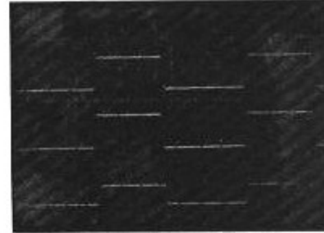
Fig. 14 : Ajustage du circuit déphaseur à 10 kHz. V_e = 0,72 V (2 V/c) V_s = 10 V/c .
