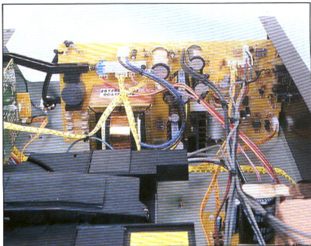
Vue de la carte d'alimentation avec son transformateur à multiples enroulements secondaires et les nombreux circuits de régulation.
