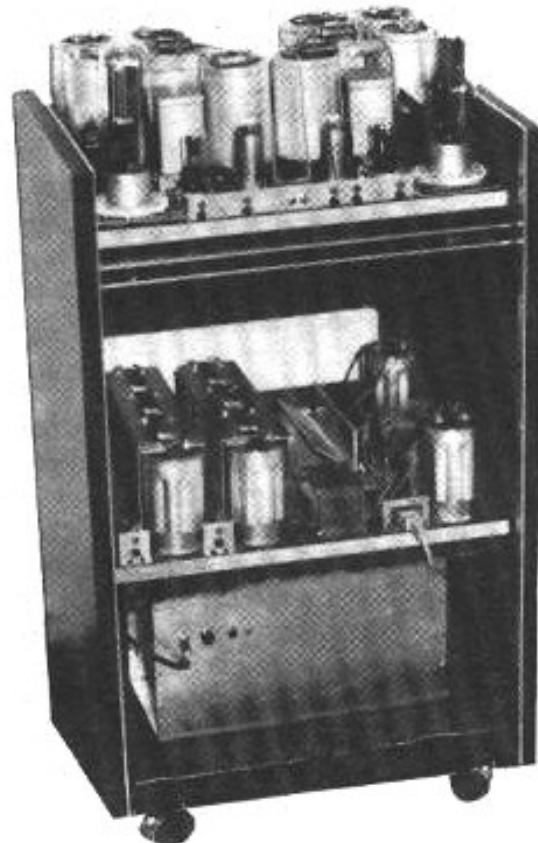
Projet d'amplificateur à lampes de 2x7 watts. Son poids atteint 100 kg.
