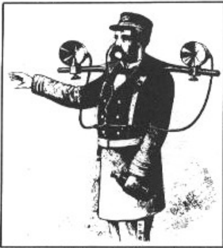
Fig. 13 : L'écoute binaurale ! Ce topophone (1880) augmente le pouvoir de localisation par l'intermédiaire de deux pavillons largement écartés ; il était destiné aux capitaines de bateaux afin qu'ils puissent déterminer avec précision la direction d'une sirène dans le brouillard (doc. Time Life 1965).
