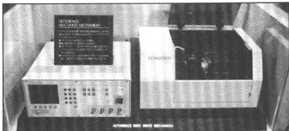
Système de lecture de référence destiné principalement aux mesures de la firme Kenwood, le « Reference Disc Drive Mecanism ».
