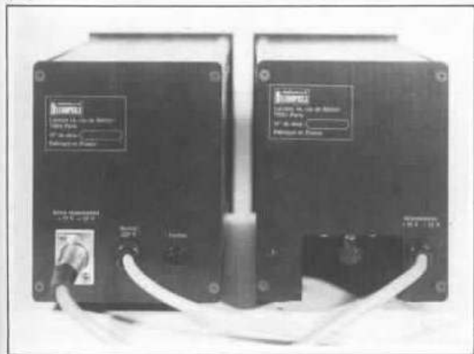
Fig. 4 : Vue de l'arrière des boîtiers, un dégagement important a été prévu à l'arrière du boîtier circuit pour permettre le passage des câbles de connexions entrée-sortie.
