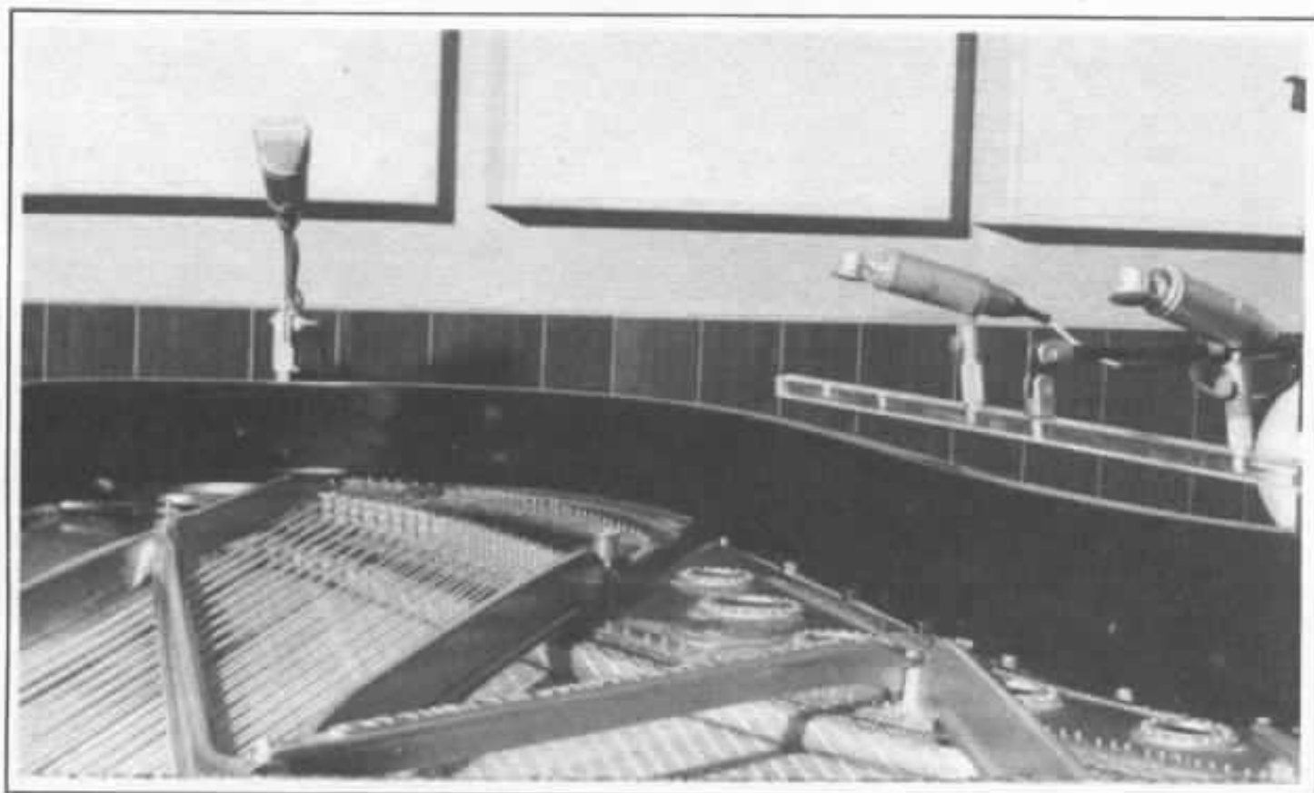
Fig 4. : Position des micros au-dessus des cordes du piano « Steynway » : un Neumann U 87 pour les basses et deux « Schoeps » avec préamplis Geneix pour les fréquences aiguës.
