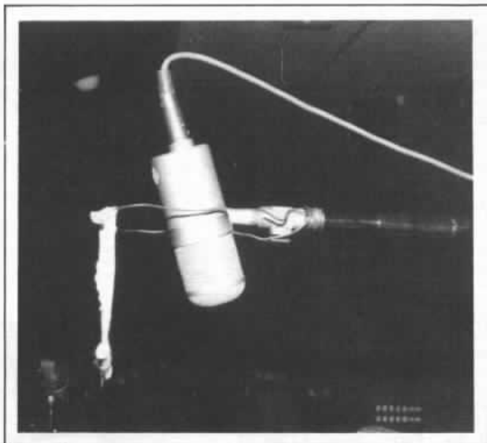
Fig. 23 : Morceau de tissu placé devant un micro Neumann U 47 pour atténuer les « explosives » de la voix.
