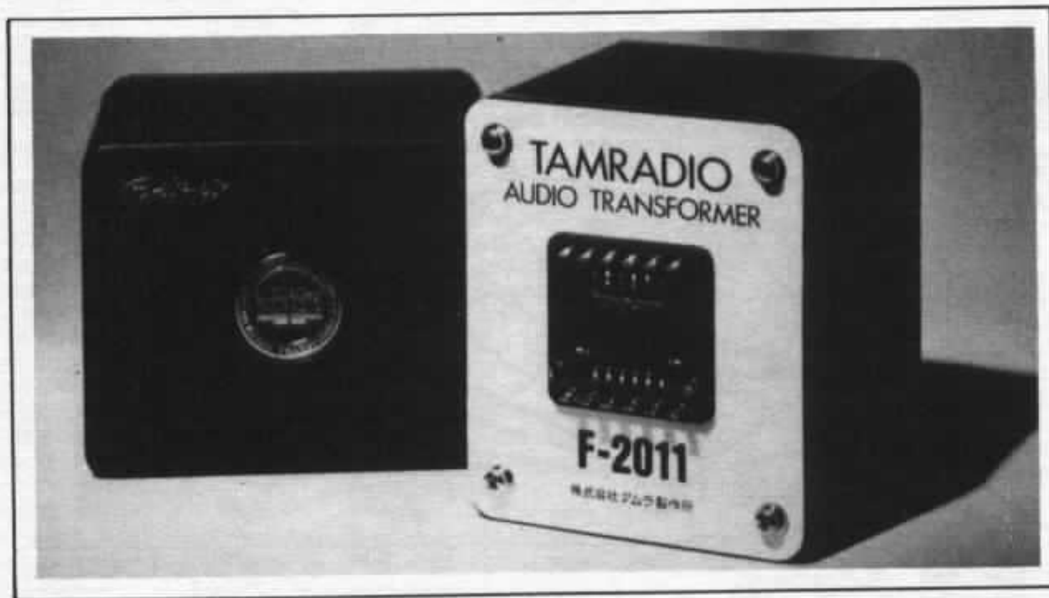
Transformateur de sortie Tamura F 2011. Puissance admissible 100 \text{ W} ( 150 \text{ W} à 50 \text{ Hz} ). Bande passante 5 \text{ Hz} à 100 \text{ kHz} à -1 \text{ dB} entre 1 et 100 \text{ W} . Enroulements spéciaux de cathode « C.R.K. ».
