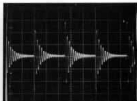
Fig. 34 - Courant dans un court-circuit, pour une tension d'attaque de l'amplificateur mettant en évidence le début de la limitation; échelles : 10 \text{ A/carr.} , 0,5 \text{ ms/carr.}
