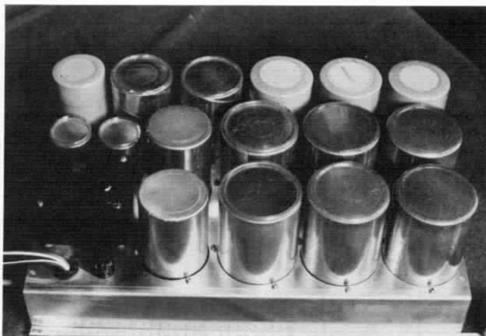
Alimentation du préamplificateur SRPP. (Réalisé par Mr Tanaka). Cette alimentation comporte 6 condensateurs de chacun 2000 \mu F 500 V soit un total de 12,000 \mu F.
