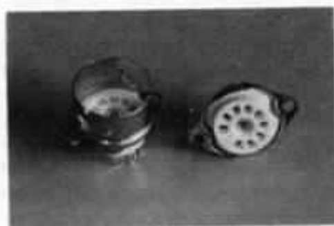
Supports stéatite noval utilisés. A gauche un modèle avec blindage.
