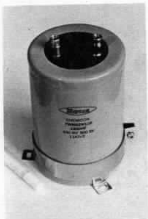
Condensateur électrochimique de très forte valeur (1000 \mu F, 450 V) utilisé sur le préamplificateur SRPP. Diamètre 75 mm, Hauteur : 12 cm.
