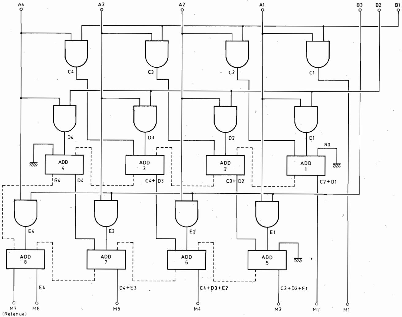
Fig. 5. — Schéma complet du multiplicateur binaire parallèle 3 × 4 bits.
