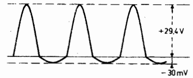
Fig. 9. - Représentation de la tension redressée.
