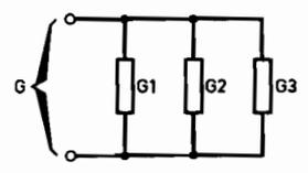
**Exemple :** Nous avons trois résistances en parallèle :  $R_1 = 20 \Omega$ ,  $R_2 = 50 \Omega$  et  $R_3 = 100 \Omega$ .
