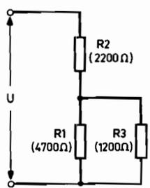
**Exemple :** Quelle est la valeur du courant traversant les résistances  $R_1$  et  $R_3$ , la tension  $U$  étant égale à 12 V ?
