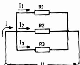
**Exemple :** Un circuit est composé de trois résistances en parallèle :  $R_1 = 20 \Omega$ ,  $R_2 = 50 \Omega$  et  $R_3 = 100 \Omega$ . Ces résistances sont placées aux bornes d'une source de 10 V. Nous voulons connaître : la résistance totale, le courant et la puissance dissipée dans chaque résistance.
