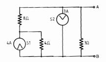
On remarque que, vu la polarité de la source de tension, le courant généré par la source équivalente est en opposition avec le courant de S<sub>1</sub>.
