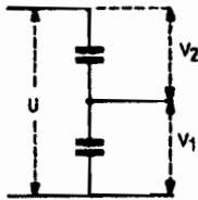
**Important :** La tension aux bornes des condensateurs est inversement proportionnelle à la capacité.
