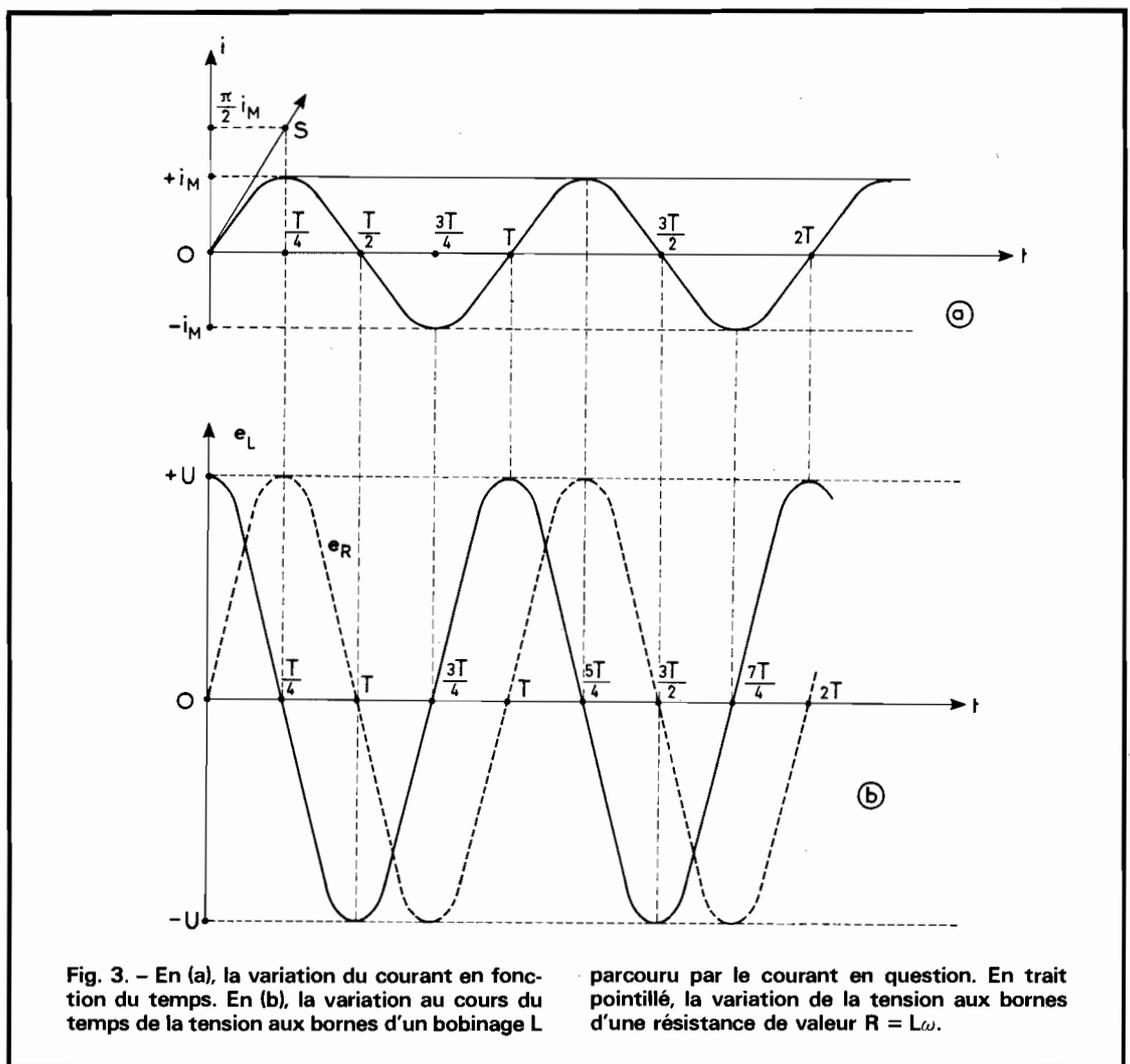
Fig. 3. - En (a), la variation du courant en fonction du temps. En (b), la variation au cours du temps de la tension aux bornes d'un bobinage L parcouru par le courant en question. En trait pointillé, la variation de la tension aux bornes d'une résistance de valeur  $R = L\omega$ .
