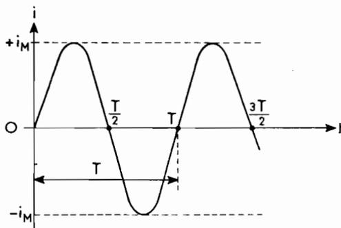
Fig. 1. - Un courant alternatif sinusoïdal oscille entre une valeur  $+i_M$  (valeur crête ou maximale) et une valeur  $-i_M$ . Le phénomène se reproduit identiquement après un temps  $T$  appelé sa « période ». L'inverse de  $T$  est la « fréquence ».
