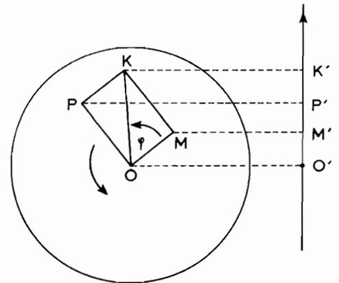
Fig. 7. - Pour montrer l'addition des tensions  $e_R$  et  $e_L$  de la figure 6, on va les figurer par des mouvements d'ombres sur le tourne-disque. La somme des projections de OM et de OP est égale à la projection de la diagonale OK du rectangle.
