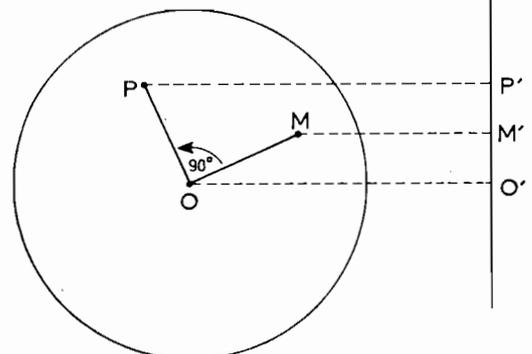
Fig. 5. - Si deux objets  $M$  et  $P$  sont posés sur le plateau d'un tourne-disque, avec un angle  $MOP$  de  $90^\circ$ , les ombres  $M'$  et  $P'$  exécutent deux mouvements sinusoïdaux déphasés d'un quart de période.
