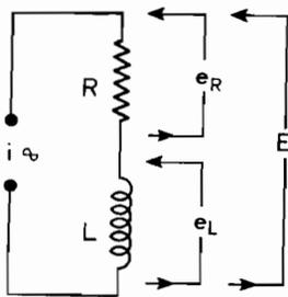
Fig. 6. - Le même courant alternatif passe dans le résistor R et dans le bobinage L. On trouve une tension efficace  $e_R$  aux bornes de R,  $e_L$  aux bornes de L mais la tension efficace E aux bornes de l'ensemble n'est pas égale à la somme arithmétique de  $e_L$  et  $e_R$  : il faut tenir compte de leur déphasage.
