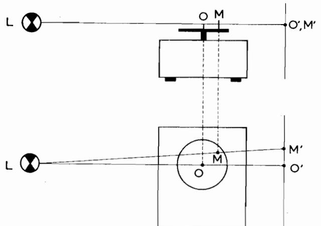
Fig. 2. - Pour matérialiser un mouvement sinusoïdal, un bon moyen est de projeter sur un mur l'ombre  $M'$  d'un objet  $M$  posé sur le plateau d'un tourne-disque. L'expérience est représentée ici en plan et en élévation.
