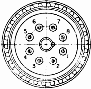
Fig. II-2 - Branchement du culot du tube 4 x 150 A et des tubes similaires
