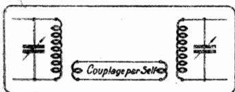
FIGURE 22. — Le montage avec selfs de ligne indépendantes est plus facile à mettre en application que le précédent et présente en outre l'avantage de permettre un couplage variable à chaque extrémité de la ligne.
