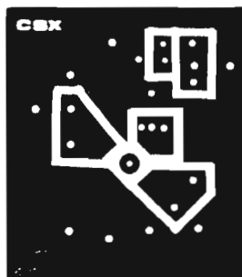
Fig. 4. – Dessin et implantation du circuit imprimé du préamplificateur – Percer un trou de \varnothing 5 mm à l'emplacement du transistor – Le transistor est monté côté cuivre.
