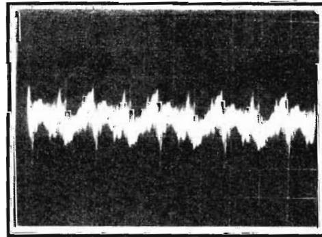
PHOTO H. – Avec un simple trace, le résidu harmonique peut être observé de même, en synchronisant sur la sinusoïde, en mode « Sy Ext ».
