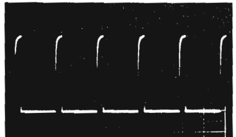
Oscillogramme C. — Un train de six impulsions observé en mode normal.
