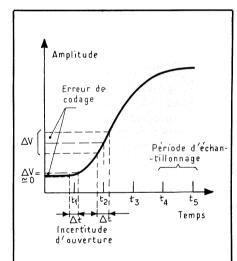
Fig. 7: La quantification du signal.
