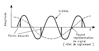
Fig. 4 : Un signal dont la fréquence est supérieure à la moitié de la fréquence d'échantillonnage donne lieu à une fausse représentation.
