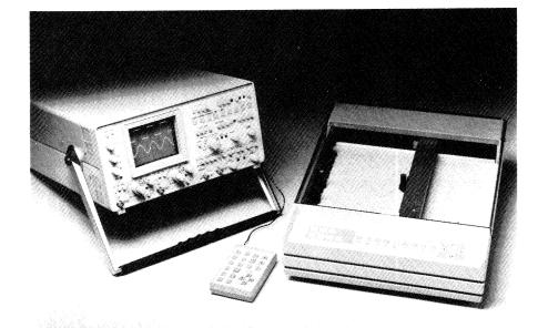
Fig. 16 : Ressortie des informations sur table traçante numérique. Sans nécessiter de calculateur, le GOULD 4050 reproduit les traces en couleur en graduant les axes suivant les réglages de l'appareil.
