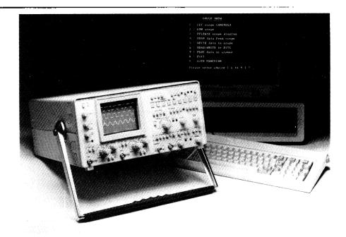
Fig. 17 : Le 4050 connecté à un IBM-PC par l'intermédiaire du bus IEEE-488.
