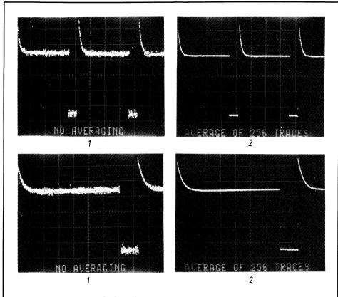
Fig. 13: Signal sorti du bruit par le moyennage: (1) sur un balayage, (2) 256 balayages.
