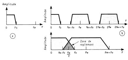
Fig. 5 : Echantillonnage d'un signal contenant un spectre de fréquences.
