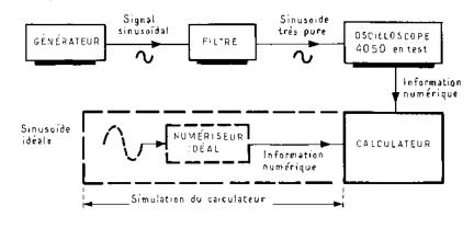
Fig. 9 : Principe de la méthode de mesure de la résolution effective.
