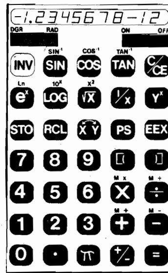
Fig. 2. - Avec un seul circuit intégré, tel que le 7529-07 (introduit en juin 1975) de MOS Technology Inc., il est possible de réaliser un calculateur ayant 18 fonctions scientifiques, une mémoire adressable (les 4 opérations arithmétiques y sont réalisées directement), capable d'afficher 12 chiffres, et travaillant en notation scientifique (avec 2 niveaux de parenthèses).
