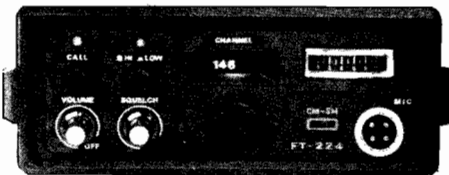
SOMMERKAMP FT-224 Transceiver, 1/10 W, 24 canaux FM, tous équipés de cristaux pour des répéteurs européens et des canaux simplex. Le transceiver idéal pour le radio-amateur F1 n'opérant pas en CW.
