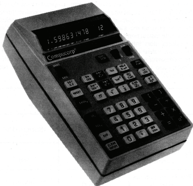
Photo 12. - Le modèle 324 G « scientifique » de COMPUCORP est programmable et dispose de deux mémoires capables de stocker, chacune, jusqu'à 80 pas de programmes.
