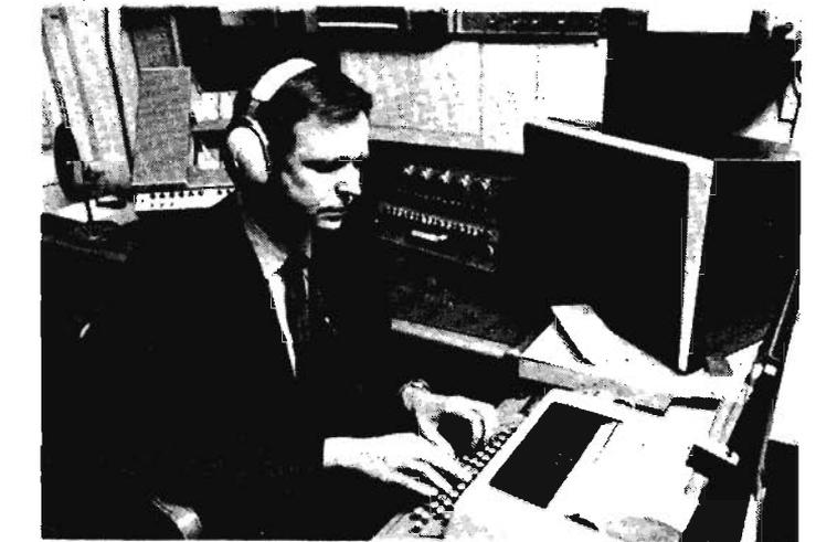
Photo 30. — Cecil H. Coker, à la console d'un ordinateur des Bell Telephone Laboratories, tape un texte au clavier ; la machine lit oralement le texte frappé, tandis que sur l'écran cathodique apparaît une bouche humaine qui reconstitue les mouvements des organes sonores humains.
