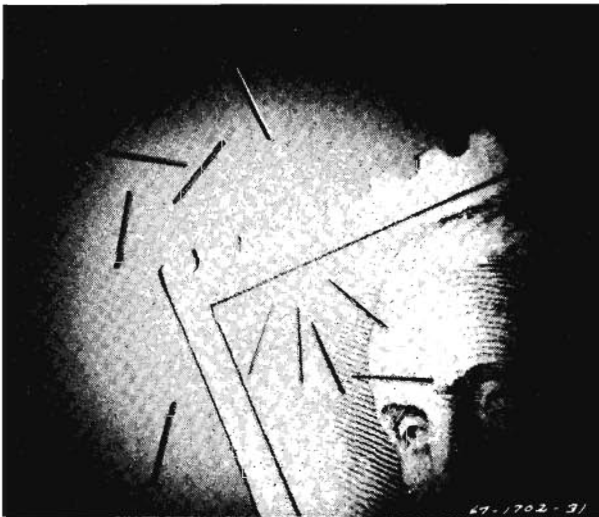
Photo 4. — La mémoire centrale de l'ordinateur NCR Century est constituée de mini-aiguilles d'un diamètre de 0,15 mm et longues de 2,7 mm. Ces aiguilles sont sept fois plus rapides et quatre fois moins chères que les tores de ferrite.
