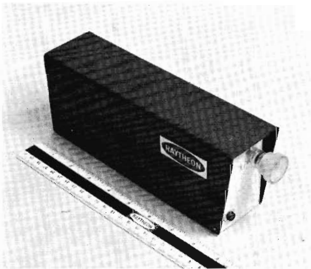
Photo n° 1. — Commutateur de faisceau laser : un tel appareil sera utilisé dans les futures communications optiques. (Cliché Bell Telephone Laboratories)
