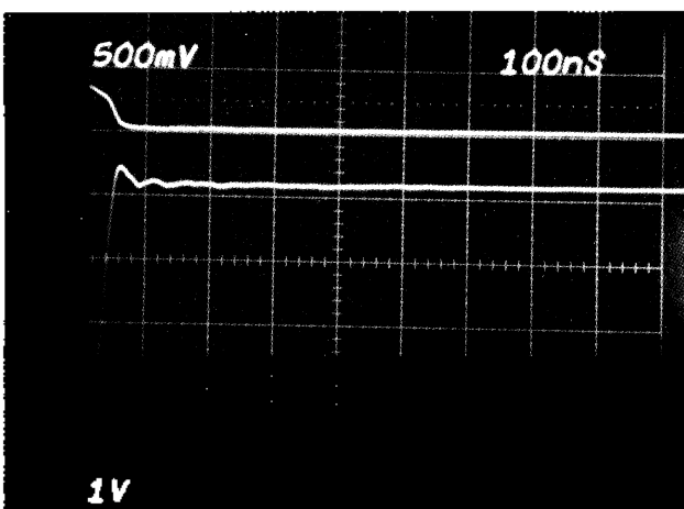
(a) En haut, courant drain : 5 A/div. 100 ns/div. En bas, tension drain : 100 V/div. Courant de sortie : 20 A.
